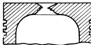
Fig. 9.18 Spargerea pistonului în cazul arderii detonante
